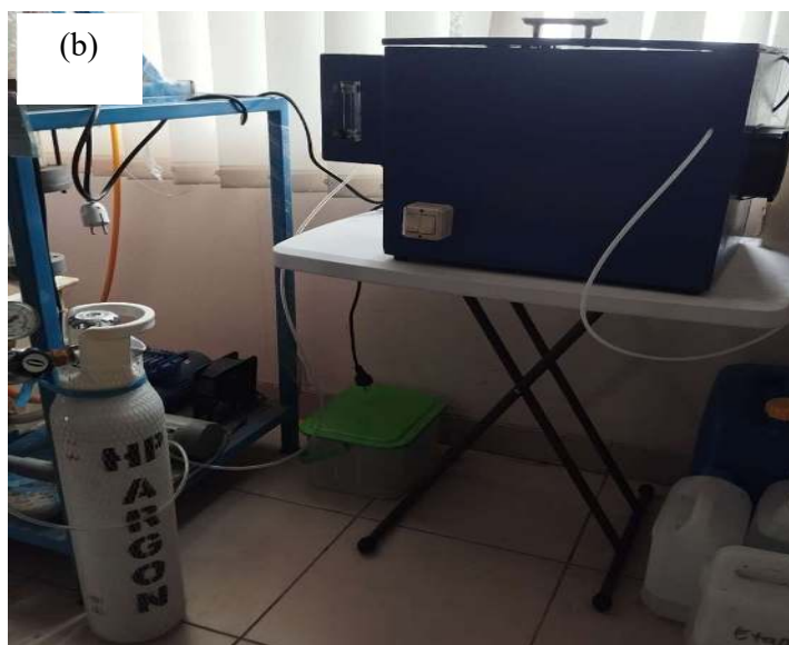
Gambar 9. Reaktor PEC (a) tampak dalam dan (b) tampak luar
