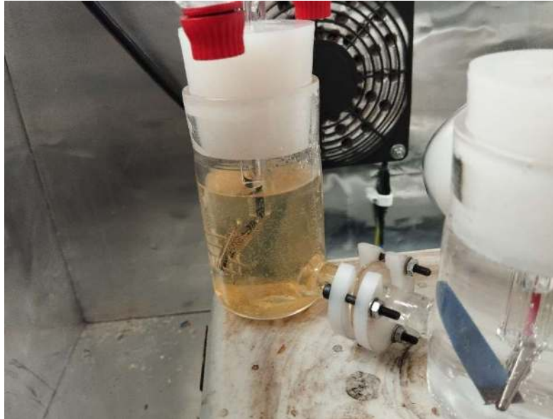
Gambar 21. Gelembung-gelembung gas hidrogen yang terbentuk selama proses fotoelektrokatalisis
